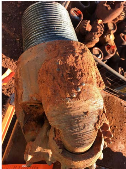
采矿现场磨损严重的钻头
