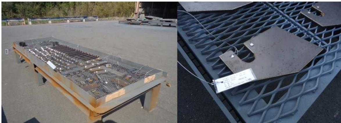
现在，供应商在将零件和组件交付给大分工厂之前将每个零件和组件都贴好了RFID标签。每个供应商在将完整的组件交付给工厂时都会收到新的订单和相应的RFID标签。
